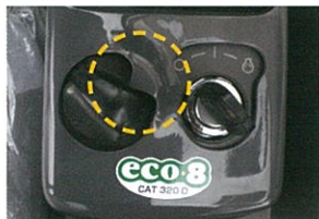
計器のアクセルが80%以上にならないように設けられたストッパー
